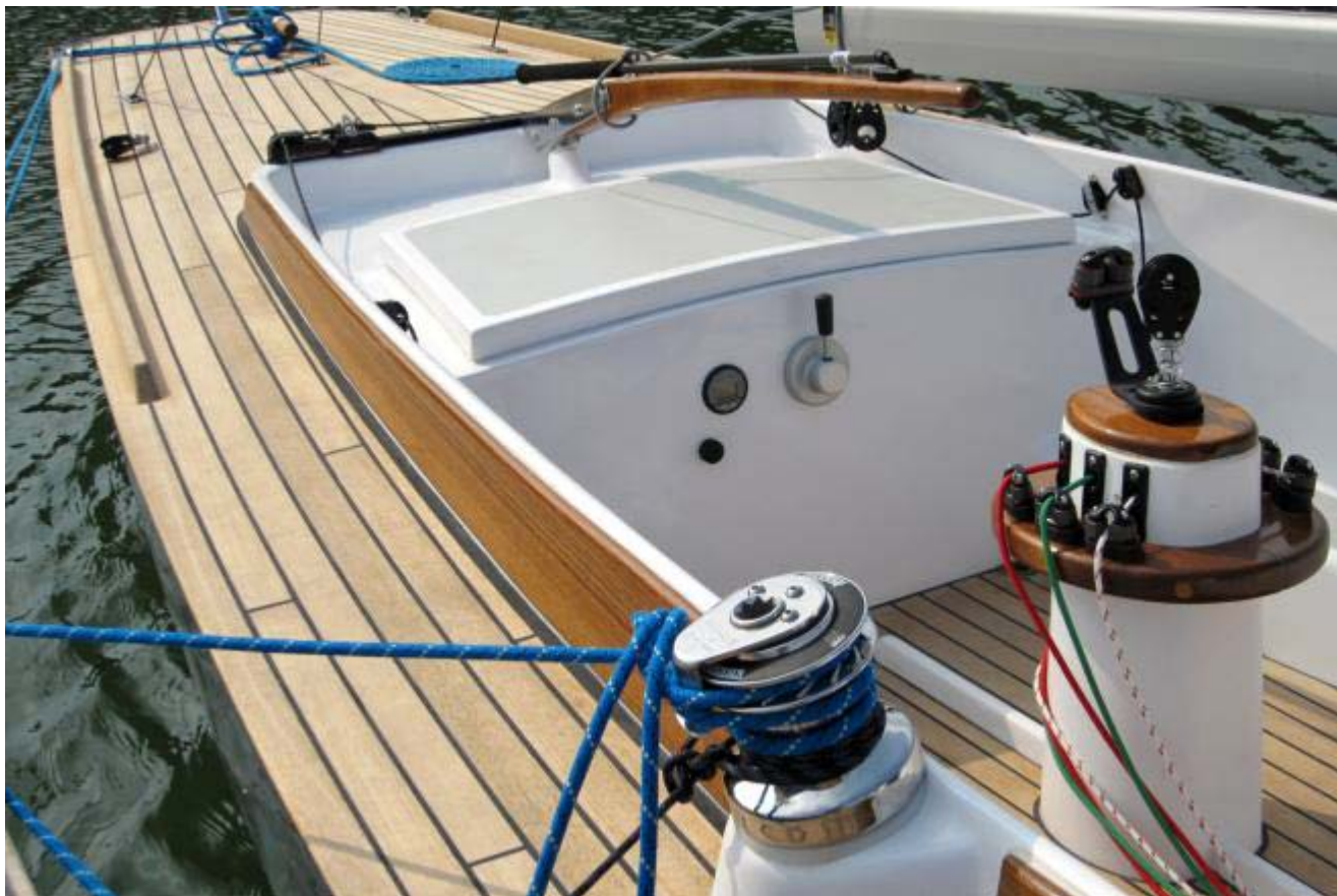
L'accastillage a été simplifié pour rendre le Requin plus accessible. Et le cockpit est autovideur – bien vu !
